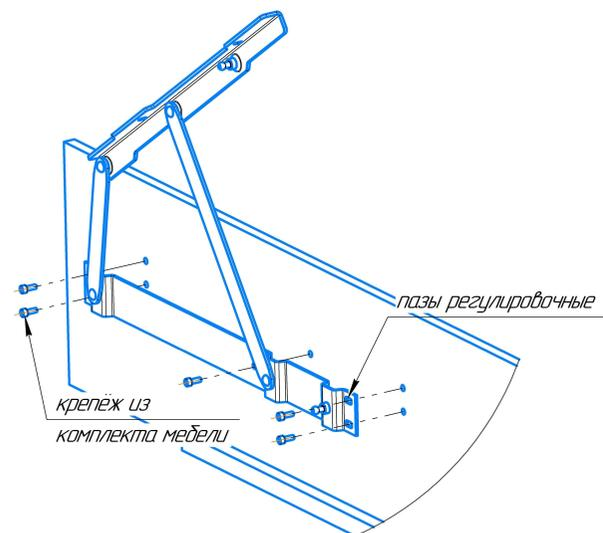
**Газовый амортизатор крепить обязательно штоком вниз (см. эскиз). Механизм подъема кровати, угол подъема 36°**
